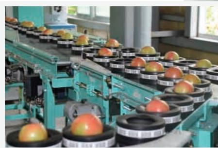
当JA七戸支管内の中集出荷所には、最新のトマト選別設備を設置しています。選別設備は、カラー内部品質センサーが装備され、トマトの色や形、外部傷害の程度などを細かく調べることができます。
